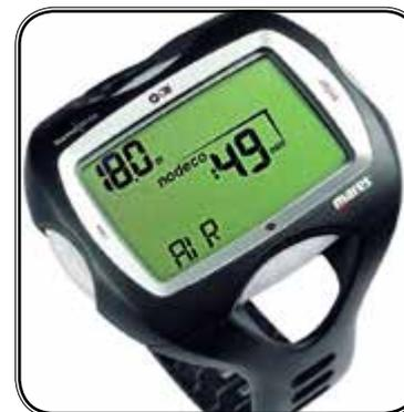
Ronilački kompjuteri su danas pouzdani i sigurni. Obično problemi nastaju usled nebrige ili fizičkog oštećenja. Ne smeju se izlagati otvorenom suncu i visokoj temperaturi jer to oštećuje displej i elektroniku. Voditi računa o zaštiti od pada ili udarca u tvrdi predmet. Nakon upotrebe treba ih oprati u slatkoj vodi i ostaviti da se osuše.
