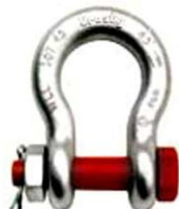
Škopac je takođe deo tehničke opreme, može biti jednostrani ili dvostrani. To je metalna alka čiju jednu stranu zatvara vijak ili čivija. Izrađuje se od čelika, inoksa i legura aluminijuma. Od materijala i dimenzija zavisi njegova čvrstina i jačina. Ima ih od materijala prečnika 4-40 mm. Služi za spajanje i produžavanje prevashodno lanca. U nautičkoj svakodnevici se obično viđa na mestu spoja sidra i sidrenog lanca. Održavanje je isto kao i kod karabinera.
